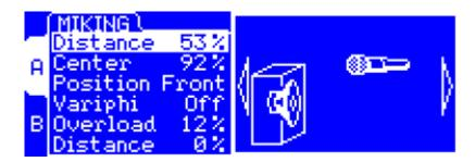
• Ce paramètre désigne la distance entre l'enceinte et le microphone simulés. Un micro proche de l'enceinte va donner un son très précis avec un effet de proximité prononcé (selon le type de micro sélectionné).
