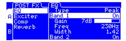
Les 4 bandes du milieu sont des filtres en cloche ayant les paramètres suivants :
