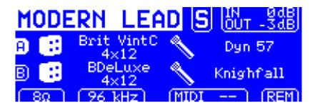
Le mode du preset sélectionné (**Simulation** or **Arcade**) est indiqué par un **S** ou un **A** dans le coin en haut à droite.
