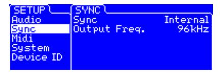
• **Sync:** Le Torpedo Studio peut être synchronisé par une horloge externe ("Wordclock") ou par des signaux numériques entrant ("S/PDIF" ou "AES/EBU"). Si vous sélectionnez une source d'horloge externe, la valeur de la fréquence ("Output Freq.") apparaîtra dans le menu SETUP quand la synchronisation du Torpedo Studio avec votre générateur d'horloge sera effective.
