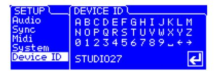
• **Device ID:** ce menu vous permet de donner un identifiant à votre machine. Vous devrez donner des identifiants différents à plusieursmachines reliées simultanément en USB au même ordinateur pour pouvoir les piloter avec le Torpedo Remote. Vous pouvez vous déplacer dans l'alphabet à l'aide de "NAVI" et sélectionner les lettres avec "OK".
