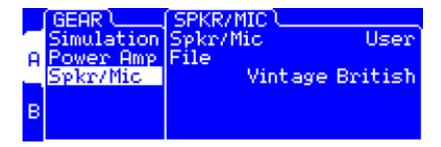
• **User:** Choisissez quelle Réponse Impulsionnelle (IR) utiliser pour la simulation. Vous pouvez créer vos propres IRs avec le logiciel Torpedo BlendIR et les charger à l'aide de Torpedo Remote. Vous pouvez aussi charger n'importe quelle IR au format .Wav. ou .aiff.
