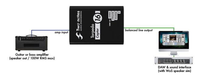
En studio, la meilleure solution est d'utiliser le signal dry de l'amplificateur et d'utiliser le plugin Wall of Sound, pour obtenir une simulation de haut-parleur plus réaliste. De plus, enregistrer le signal dry signifie que la prise de son virtuelle peut être réalisée et affinée après l'enregistrement lui-même.
