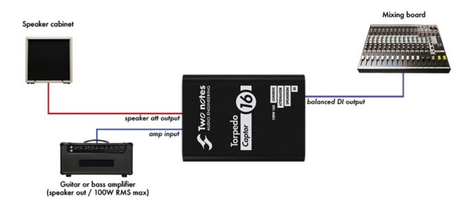
Dans cette configuration, l'ampli est connecté à la loadbox interne du Captor. Ceci signifie que l'impédance du Captor doit correspondre à l'impédance de la sortie speaker de l'ampli.
