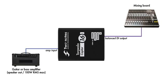
Si une prise de son silencieuse est nécessaire, pour une scène silencieuse, vous pouvez retirer l'enceinte de la configuration précédente. Connectez simplement l'ampli au Torpedo Captor, et la sortie DI à la console de mixage.
