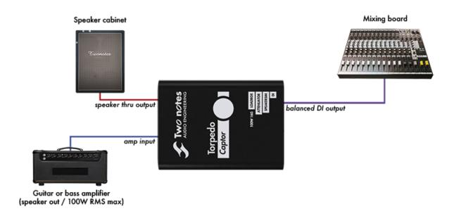
Sur scène, le Torpedo Captor brille par sa simplicité. Tout d'abord, insérez le Torpedo Captor entre l'ampli et l'enceinte. Ensuite, connectez la sortie DI à la console de mixage, activez l'alimentation fantôme 48V sur la console, et sélectionnez le mode GTR ou BASS via le switch SPKR SIM. Voilà, votre ampli est sonorisé!
