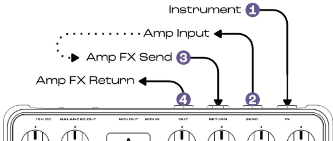
Si votre ampli possède une boucle d'effets, ajoutez les 3 canaux de ReVolt à votre ampli. Activez l'interrupteur 4-CABLE METHOD sur ReVolt, et combinez la boucle d'effets de ReVolt et de l'ampli en suivant les étapes ci-dessous:
