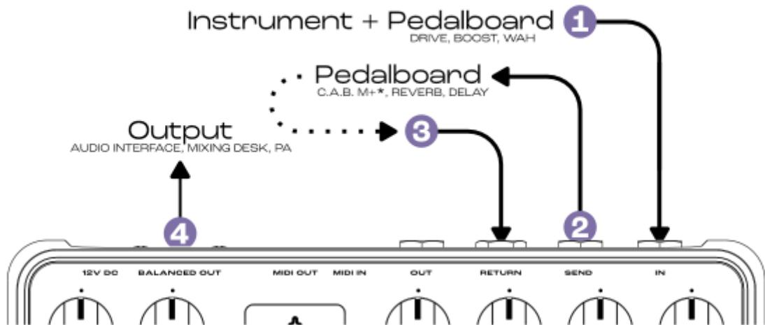
Utilisez ReVolt pour vous brancher directement aux consoles de mixages, interface audios sur scène ou en studio. Avec la simulation d'enceinte activée sur la sortie BALANCED OUT, envoyez le son complet de votre guitare et de votre pédalboard, ainsi que des effets présents dans la boucle d'effets de ReVolt.
