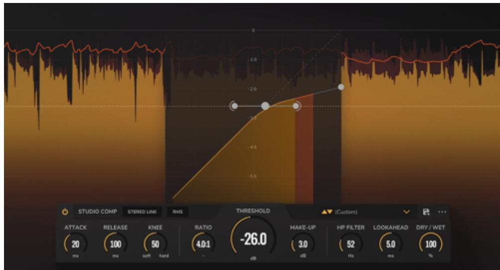
Un compresseur est indispensable pour traiter la dynamique de façon chirurgicale. STUDIO Compressor est un processeur doté de tous les réglages standards que l'on attend d'un traitement professionnel. Il dispose également d'une fonction prédictive et d'un analyseur visuel particulièrement intuitif. Il vous sera indispensable pour contrôler le contenu dynamique de votre signal. Les paramètres suivants vous permettent de configurer le STUDIO Compressor :
