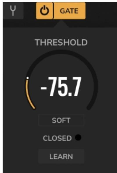
Le noise gate de GENOME est un utilitaire de correction situé dans le panneau des paramètres globaux de GENOME. Il s'active et se désactive à l'aide de l'interrupteur situé à droite de l'icône de l'accordeur.
