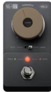
Lorsque vous avez besoin du contrôle précis d'une noise gate dans votre RIG GENOME, utilisez le composant PEDAL NG-1. Ce composant utilitaire comprend tous les paramètres nécessaires pour être placé n'importe où dans votre chaîne audio. Avec les réglages de seuil ( THRESHOLD), des modes d'ouvertures HARD/SOFT et une fonctionnalité d'apprentissage du seuil d'ouverture/fermeture (LEARN), vous aurez tous les outils nécessaires pour bannir les bruits parasites de votre signal.
