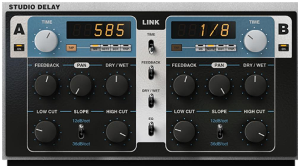
STUDIO Delay est un composant professionnel de type STUDIO développé par Two notes Audio Engineering. Son usage est exclusivement réservé à GENOME. Les temps de retard de ce delay stéréo/dual-mono peuvent être synchronisés au tempo ou configurés librement. Vous pouvez également chaîner les deux canaux, les traiter séparément avec des filtres et faire tout ce que vous pouvez attendre d'un delay professionnel, pour créer aussi bien de larges ambiances post-rock que
