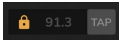
Dans GENOME, le réglage du tempo du RIG est situé en haut à droite du panneau de configuration du RIG. Il affiche le BPM actuel sauvegardé dans le RIG en cours d'utilisation. L'icône représentant un cadenas située à gauche du BPM du RIG vous donne accès aux options suivantes :
