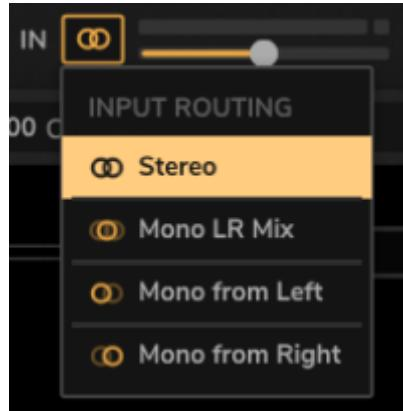
Pour configurer le routage du signal entrant dans GENOME, affichez le menu déroulant en cliquant sur l'icône située à côté de la mention « IN » dans la partie supérieure gauche du panneau des paramètres globaux de GENOME.
