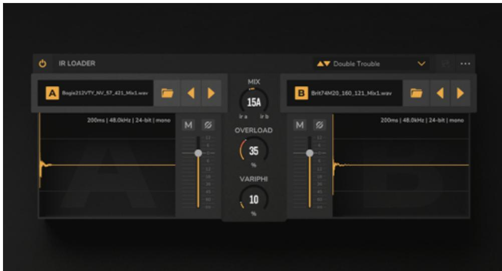
Cet outil va vous servir à charger des réponses impulsionales de baffles statiques et à utiliser deux IR statiques par instance. Il prend en charge les fichiers mono et stéréo aux formats .wav, .aiff et .tur. Voici quelques-unes des principales caractéristiques du chargeur de réponses impulsionales :
