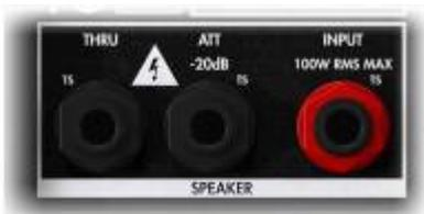
La sortie speaker de votre ampli se connecte à l'entrée SPEAKER INPUT du Captor. Vous ne pouvez pas la rater : c'est celle avec l'écrou rouge. Utilisez un câble jack d'enceinte standard pour cette connexion (une paire de conducteurs isolés, sans blindage).
