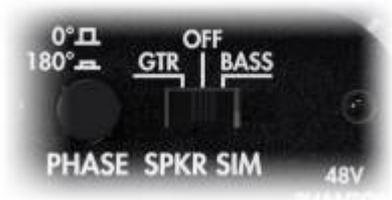
La simulation de haut-parleur peut être coupée, auquel cas le signal de la sortie DI est le signal dry provenant directement de l'ampli.
