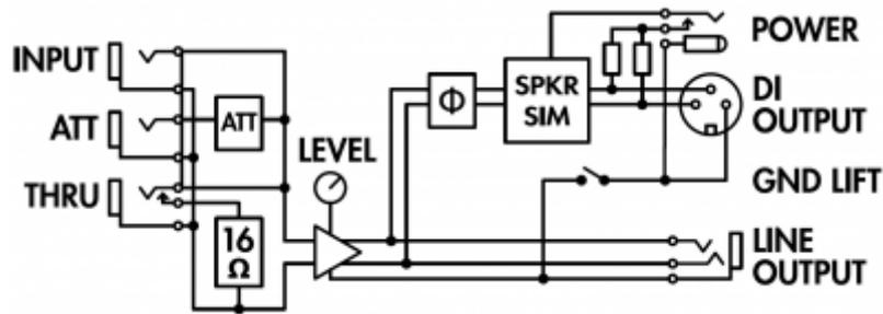
La version montrée est la version 16 ohms. Les version 4 et 8 ohms ont une loadbox de 4 et 8 ohms, respectivement, à la place de la loadbox 16 ohms.
