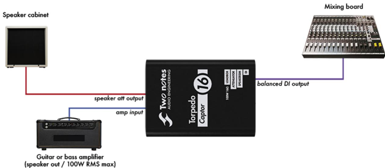
Dans cette configuration, l'ampli est connecté à la loadbox interne du Captor. Ceci signifie que l'impédance du Captor doit correspondre à l'impédance de la sortie speaker de l'ampli.
