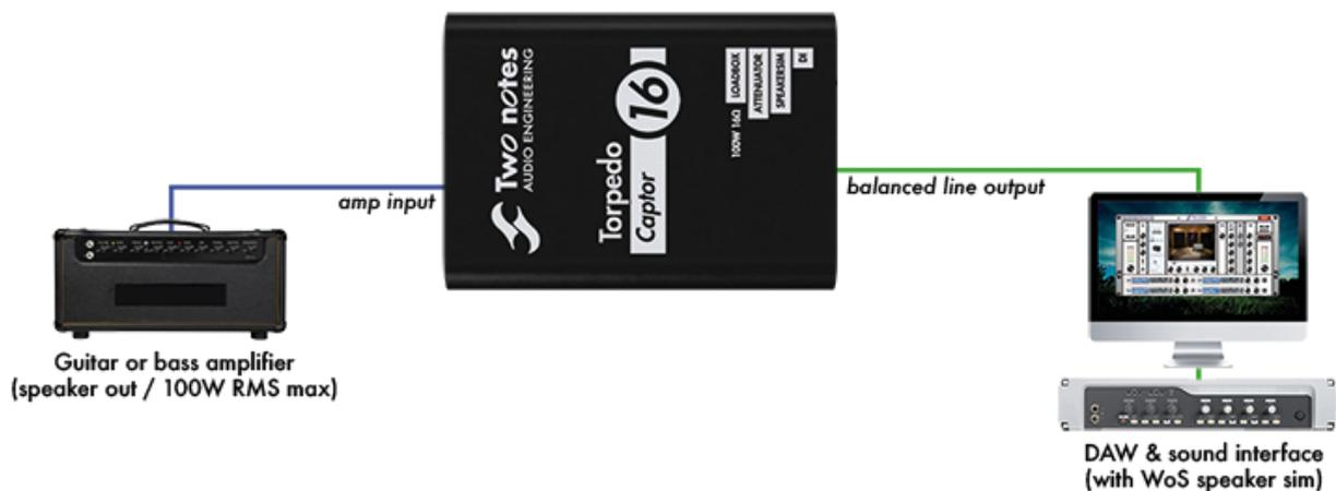
En studio, la meilleure solution est d'utiliser le signal dry de l'amplificateur et d'utiliser le plugin Wall of Sound, pour obtenir une simulation de haut-parleur plus réaliste. De plus, enregistrer le signal dry signifie que la prise de son virtuelle peut être réalisée et affinée après l'enregistrement lui-même.
